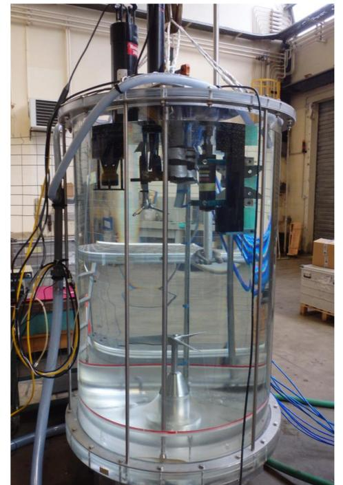
Figure 1 : Présentation du dispositif DEXMES, avec son berceau accueillant les instruments et le double système de mélange pompe + hélice
